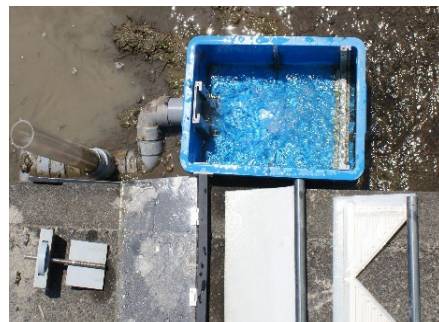
写真-1 ゲートタイプ用水位調節器 (各パーツを取り外した状態)
